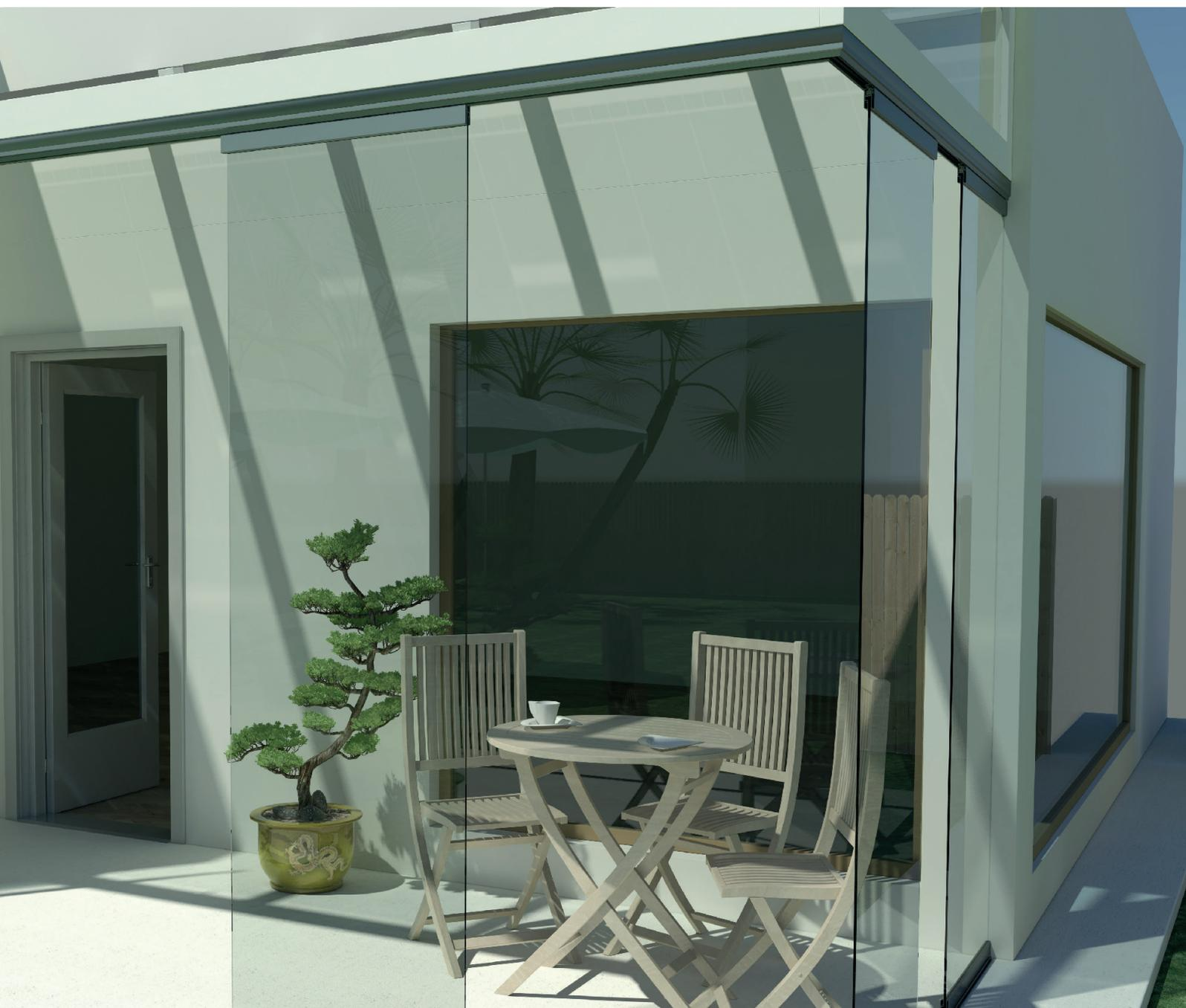
Le système de vitrage mobile sans cadre pour terrasse COVER utilise des vitrages de sécurité trempé de 8 à 10 mm selon les besoins. Grâce aux roulettes horizontales de haute qualité, le système de vitrage pour terrasse COVER peut être installé sur des terrasses droites, mais aussi angulaires. Les vitrages peuvent être ouverts complètement ou partiellement et si nécessaire en circulant à travers un angle.
